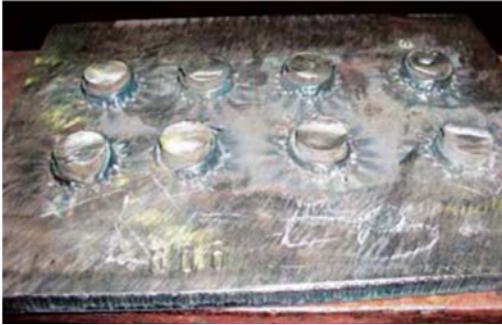
Fig. 28: Espárragos aserrados por encima del anillo de soldeo en preparación del examen radiográfico.
