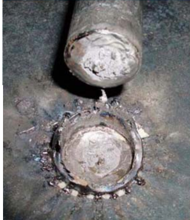
Fig. 24: Fallos causados por impedimentos para el hundimiento (insuficiente protusión) o movimientos relativos entre espárrago y pieza de trabajo después del hundimiento del espárrago.
