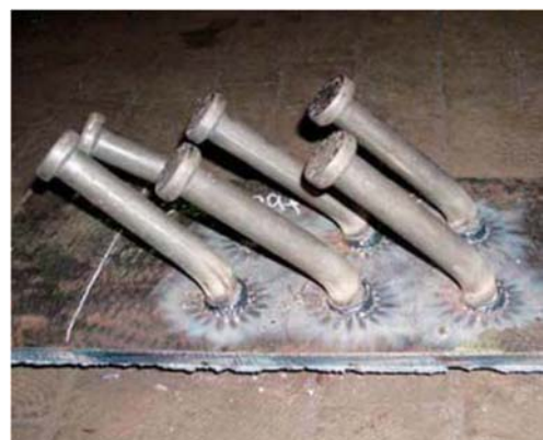
Fig. 19: Conectores de corte soldados al arco inducido, después de pasar el ensayo de doblado.
