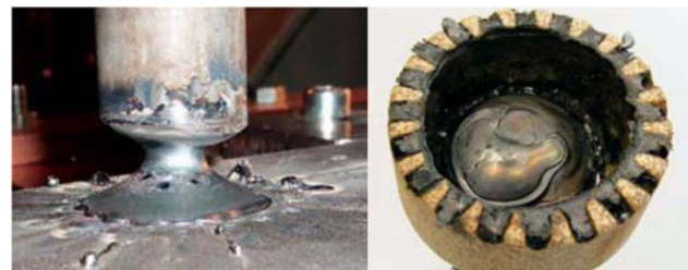
Fig. 15: Protusión insuficiente causado por el cortocircuitado del arco por goteo (izquierda) y salpicaduras entre en perno y la férula cerámica (derecha).
