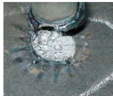
Fig. 26: Fractura en la zona de fusión producida en el ensayo de tracción, debido a fallos generalizados en la soldadura.
