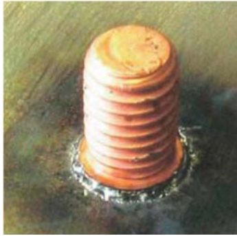
Fig. 16: Soldadura impecable de un espárrago con ignición en la punta: cerco de salpicaduras de 1,0 a 1,5 mm más ancho que el borde del espárrago.
