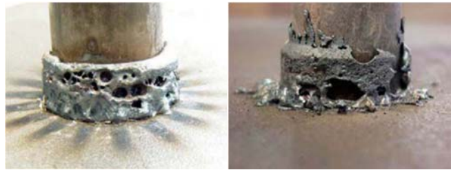
Fig. 12: Anillos de soldeo con superficie porosa y mate, resultado de unos ajustes de corriente de soldeo demasiado bajos.
