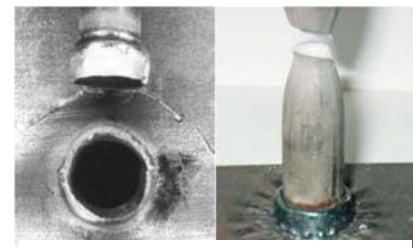
Fig. 27: Fractura fuera de la zona de afección del calor y de la zona de soldeo; el ensayo de tracción ha sido satisfactorio.
