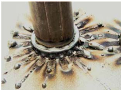
Fig. 11: Espárragos con un anillo de soldeo completo, brillante, perfectamente soldado con férula cerámica.
