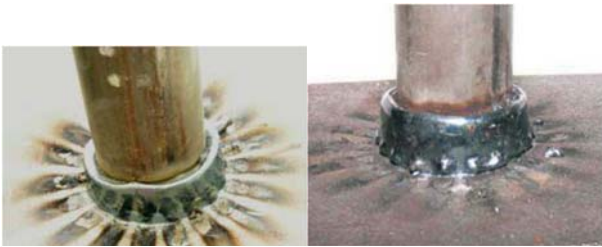
Fig. 11: Espárragos con un anillo de soldeo completo, brillante, perfectamente soldado con férula cerámica.
