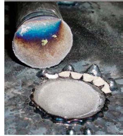
Fig. 25: Fallos causados por el movimiento relativo entre el espárrago y la pieza de trabajo durante el proceso de enfriamiento.
