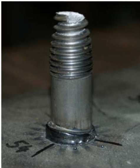
Figura 2.4: Ensayo de un M20x100-PD: fallo en la zona roscada del espárrago
