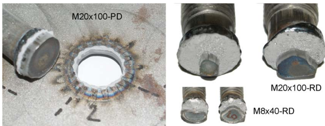
Figura 2.9: Fotos de detalle de pernos PD y RD ensayados en la serie VT de ensayos
